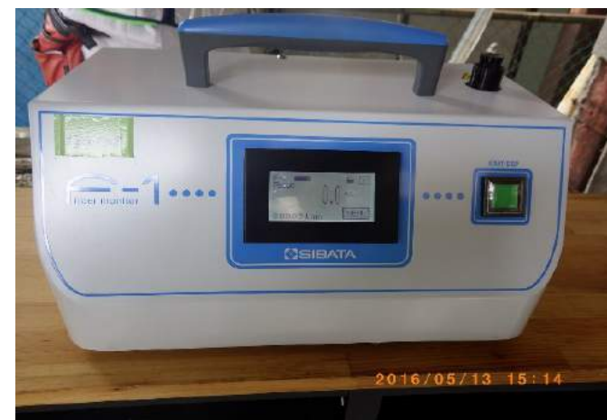
ファイバーモニター を設置して繊維の 飛散状況の調査
