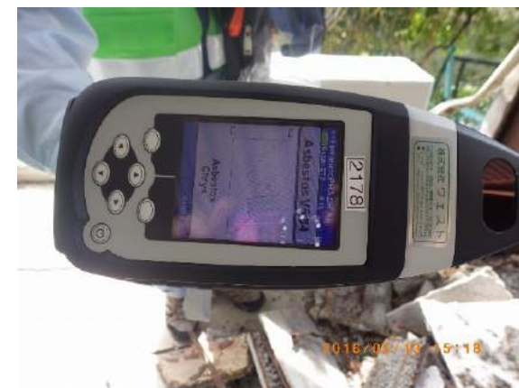
アスベストアナライザーで簡易判定 (クリソタイル含有)
