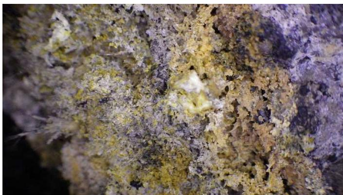
煙突断熱材の落下物 アモサイト
